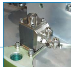
Sistema de aireación y desaeración del plato
