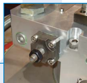
Sistema de recirculación de flujo para el control de presión
