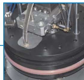
Plato teflonado con resistencias encastradas
