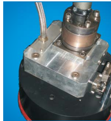
Dos salidas hidráulicas para una alimentación simultánea a varias líneas de proceso
